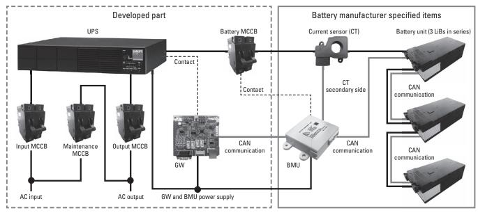
Fig. 1: System configuration of a LIB-equipped UPS
